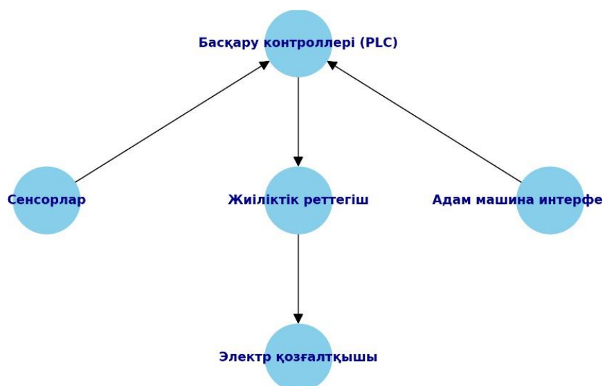
3.1 - сурет – 3 кВТ сорғы станциясының автоматтандырылған басқару жүйесінің электрлік сұлбасы
