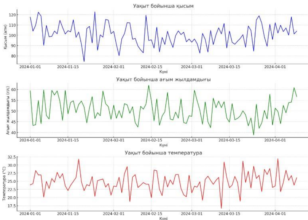
1.2 - сурет – Насос станциясының уақыт бойынша қысым, ағым жылдамдығы және температура параметрлері[3]
